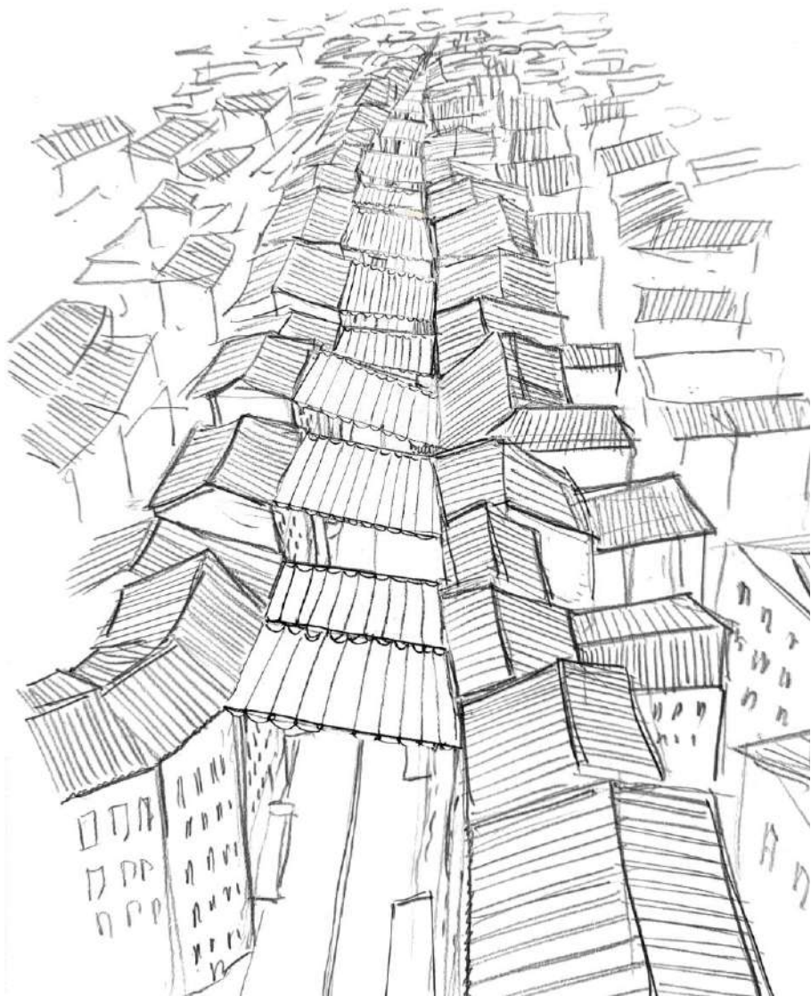
Principe de voile d'ombrage amovible proposé dans la rue Fesch
