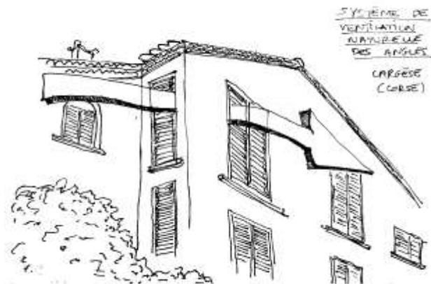
Principe de ventilation des coins observés dans le bâti ancien sur le littoral corse
