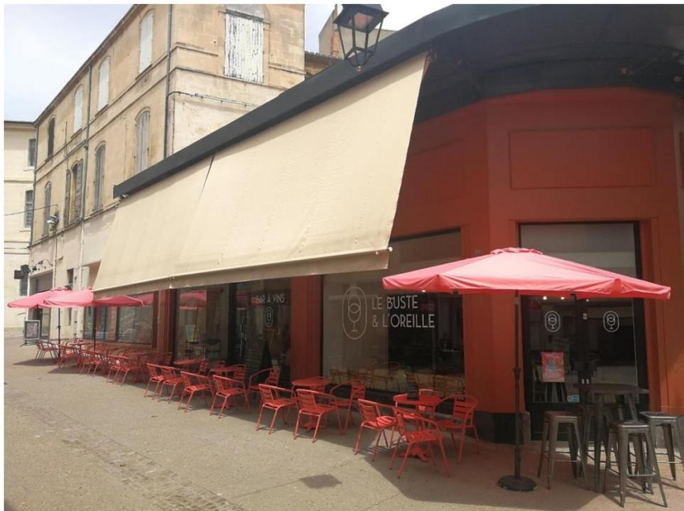
Figure 8 : Exemple de banne brise-soleil particulièrement efficace pour protéger une façade vitrée orientée plein ouest (orientation la plus défavorable du point de vue du confort thermique intérieur). Crédits : Le Buste & L'oreille.
